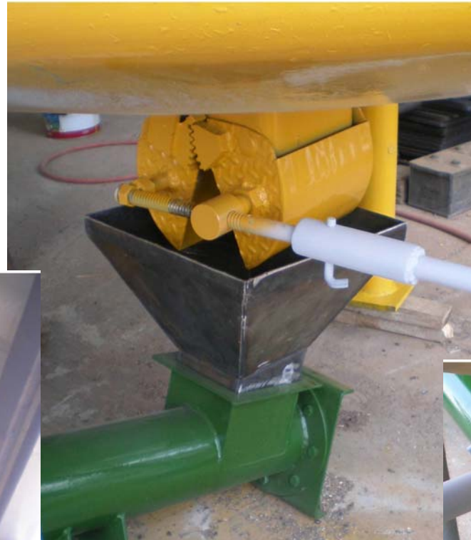
b) Engranajes de motor a helicoide, accionada por cadena, mostrando la salida del material transportado.
