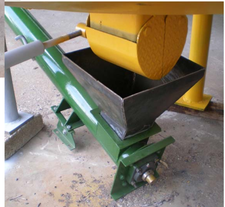
c) Otra vista de la boquilla del dosificador, se aprecia el eje del helicoide y su soporte.
